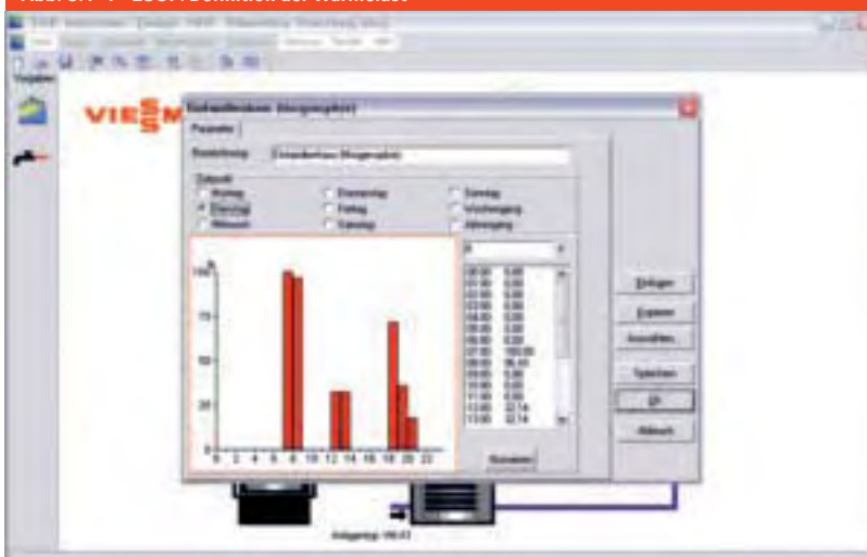
Abb. C.4-4 ESOP: Definition der Wärmelast
