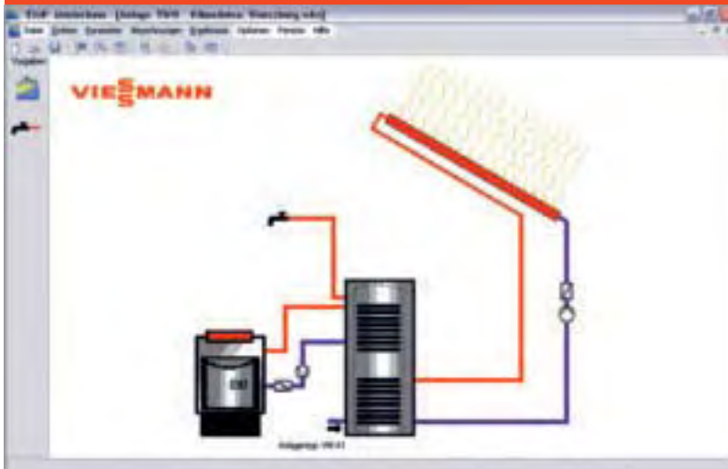
Abb. C.4-2 ESOP: Solaranlage zur Warmwasserbereitung
