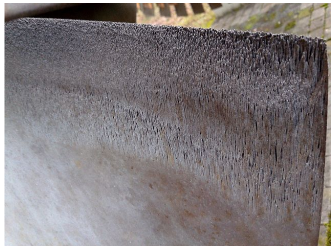
Abbildung V-4: Erosion einer Dampfturbine (Gsälzbär, 2013)
