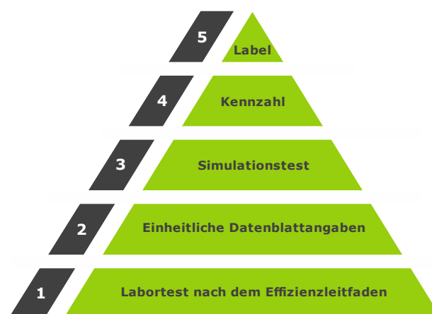
Bild 1.4 Maßnahmen zur Verbesserung der Vergleichbarkeit von netzgekoppelten PV-Batteriesystemen.
